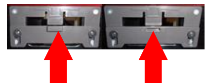
矢印の方向へシャッターを持ち上げます
